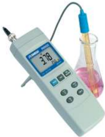
pH-մետր. օգտագործվում է ավտոմատ կերպով լուծույթի pH- ը որոշելու համար
