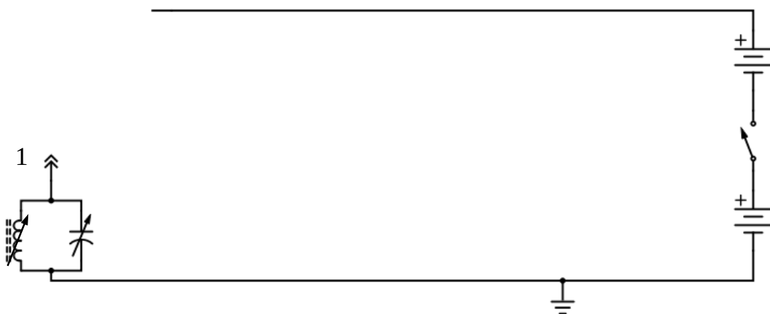
Рис. 20. Установка колебательного контура.
