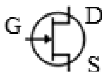
Рис. 7. Транзистор: D – сток, S – исток, G – затвор.
